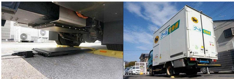
<図-9 非接触充電システム製作・設置完>
